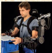
Körpergetragenen Assistenzsysteme werden immer häufiger in Produktions- und Industrie-Umgebungen eingesetzt, um Arbeitsbedingungen zu verbessern und Erkrankungen des Muskel-Skelett-Systems vorzubeugen. Auch das am Fraunhofer IPA entwickelte Exoskelett »Stuttgart Exo-Jacket« wurde entwickelt, um den menschlichen Körper beim Heben und Tragen von Lasten aktiv zu unterstützen.
