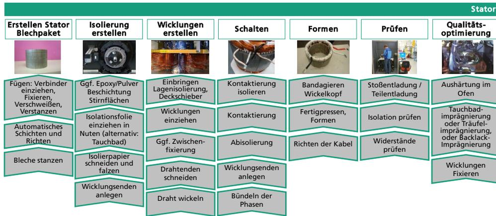
**Abbildung 23: Wesentliche Prozessschritte in der Statorherstellung (Grafik: Fraunhofer IAO)**
